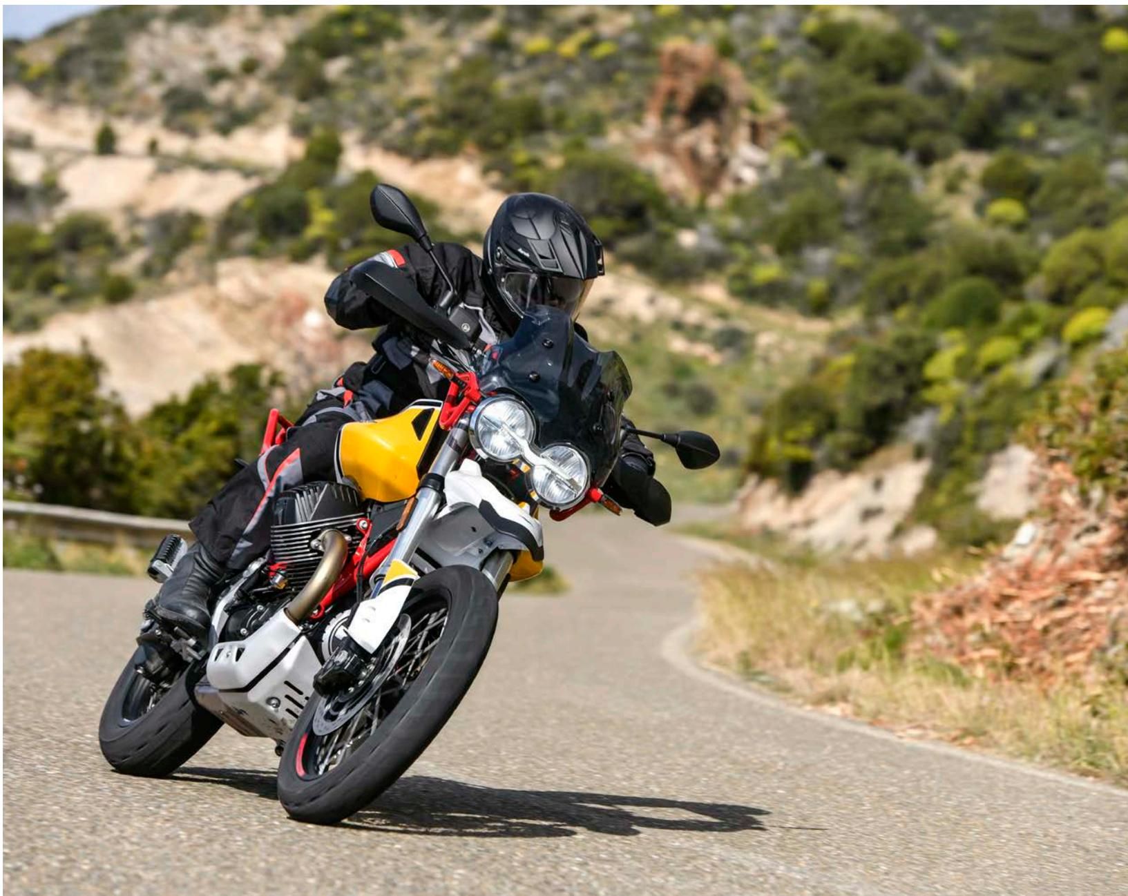
CV a 7.750 rpm –hay una versión con kit de limitación para carnet A2- con un par aumentado para buen uso off road de 8 mkg a 5.000 vueltas. El toque moderno llega al disponer de tres modos de motor (carretera, lluvia y off road), que se pueden escoger en marcha, además de tener control de tracción –desconectable en off road-, pero no configurable.
