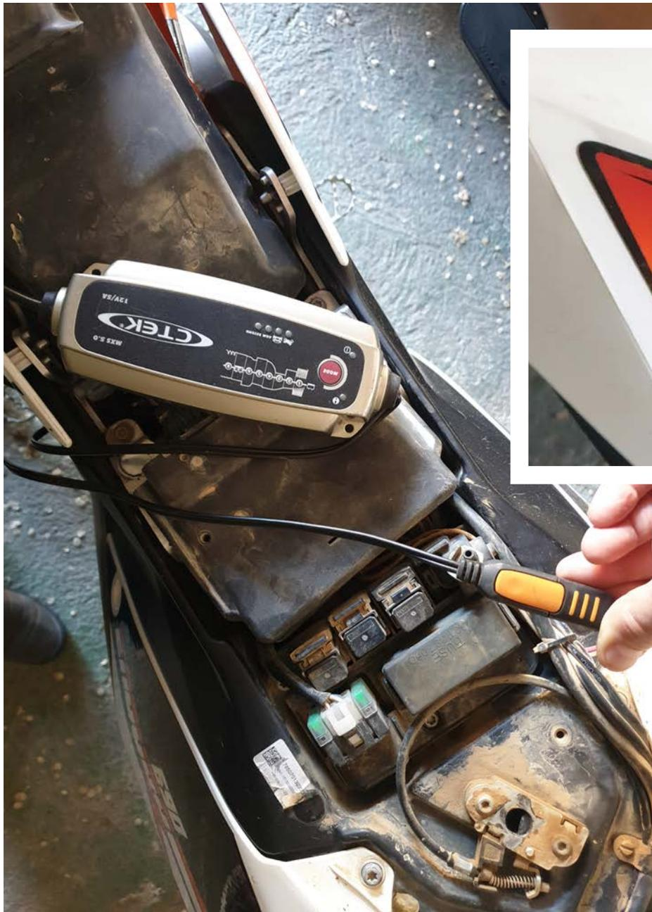
chequeo electrónico del encendido, normalmente siempre existe un consumo y antes de desconectar la batería tendremos que "engañar" al sistema, algo que se puede hacer de una manera muy fácil ya que antes de desconectar la batería pondremos nuestra moto en el modo de encendido, con el contacto dado y lista para "apretar" el botón de arranque. Será en ese momento cuando podamos proceder a desconectar el polo negativo de la batería o a desmontarla, las dos opciones que proponemos a continuación.
