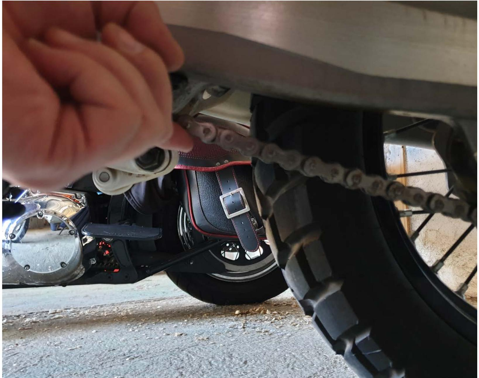
Si es así, debemos cambiar ambos elementos de la tracción secundaria y para hacerlo lo primero será aflojar los tornillos de piñón y corona sin sacarlos de su emplazamiento original, pues de esa manera será más fácil aflojarlos al bloquear la rueda con una marcha y, si es necesario, requerir la ayuda de alguien para ejercer mayor presión en el sistema con el freno trasero.
